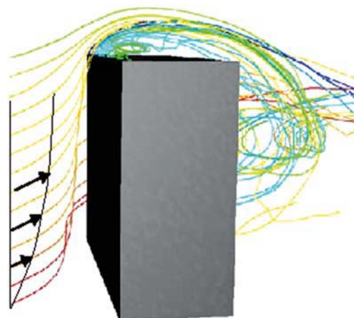
Modélisation des turbulences en toiture d'un bâtiment.
