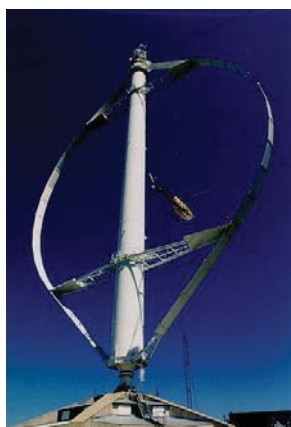
Éolienne dite de Darrieus à axe verticale.
