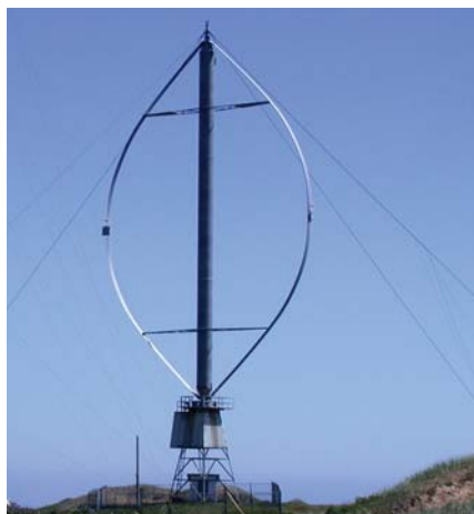
Éolienne à axe vertical.
